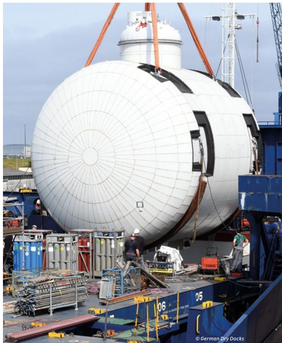
Gigant: Der 500 m 3 umfassende LNG-Tank für das Containerschiff WES AMELIE
