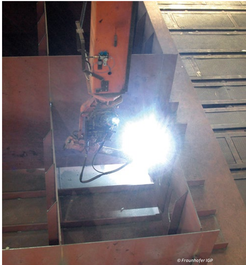
Einsatz: Roboter beim kollisionsfreien Schweißen
