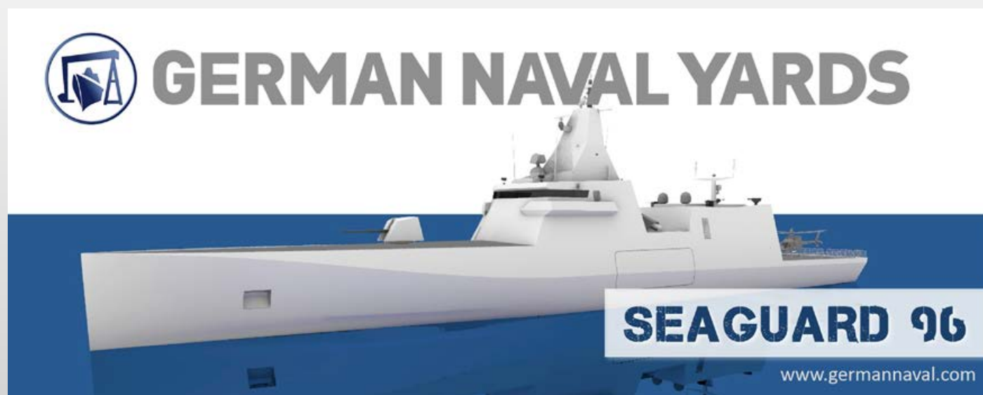
SEAGUARD 96 . Die neue Korvette zeichnet sich durch einen auffällig schlanken Bug aus. Dadurch sollen sich die Seetüchtigkeit und die Effizienz verbessern.
