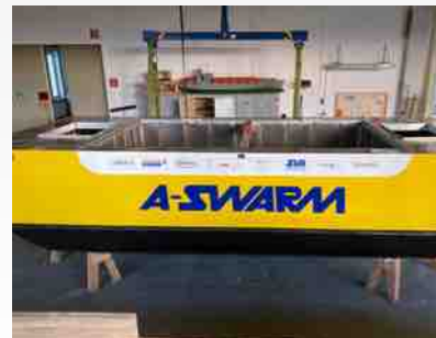
TESTPHASE. Das MUM-Funktionsmodell „Monique“ ist ein unbemanntes, modular aufgebautes Unterwasserfahrzeug.
