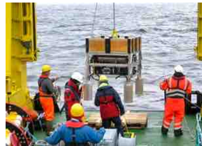
EINSATZ. Absetzen der Tiefsee-Unterwasserbodenstation auf hoher See im Rahmen des Projektes SMIS.
