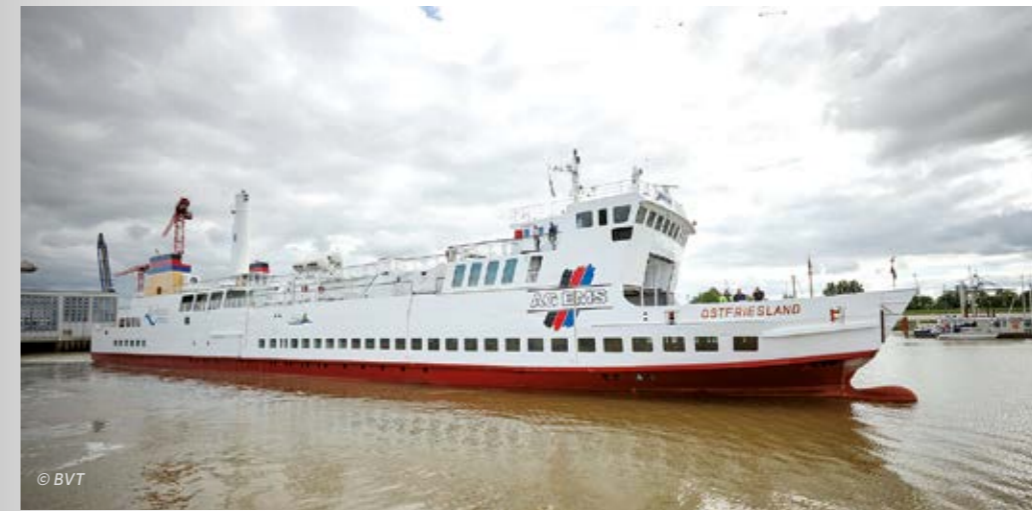
Fährschiff OSTFRIESLAND nach der Umrüstung auf einen LNG-Antrieb, 1.200 Passagiere und 70 PKW
