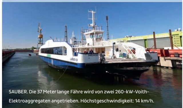
**SAUBER.** Die 37 Meter lange Fähre wird von zwei 260-kW-Voith-Elektroaggregaten angetrieben. Höchstgeschwindigkeit: 14 km/h.
