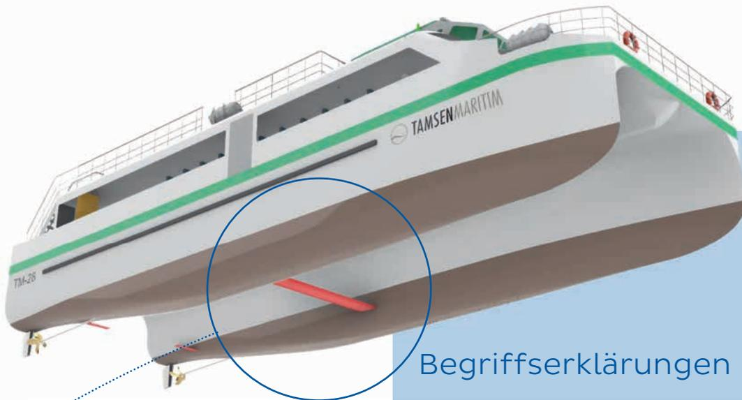
**AUFTRIEBSHILFE.** In dieser Konfiguration heben die Foils den Rumpf nicht vollständig aus dem Wasser, verhelfen dem Schiff jedoch bereits zu einer wesentlichen Widerstandsreduktion.
