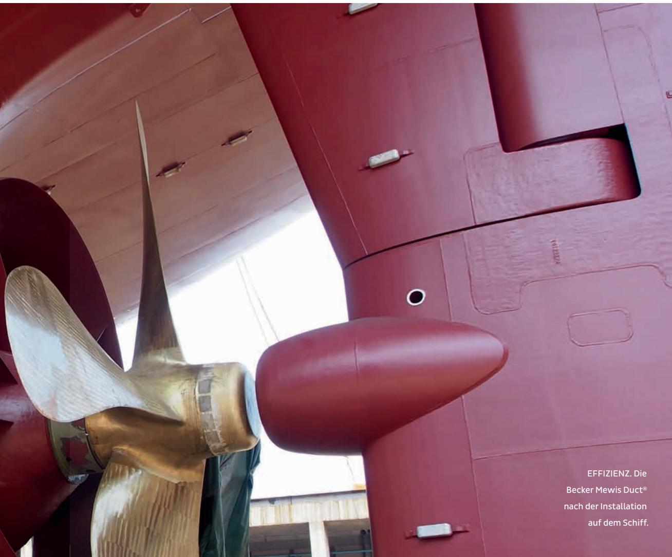
EFFIZIENZ. Die Becker Mewis Duct® nach der Installation auf dem Schiff.
