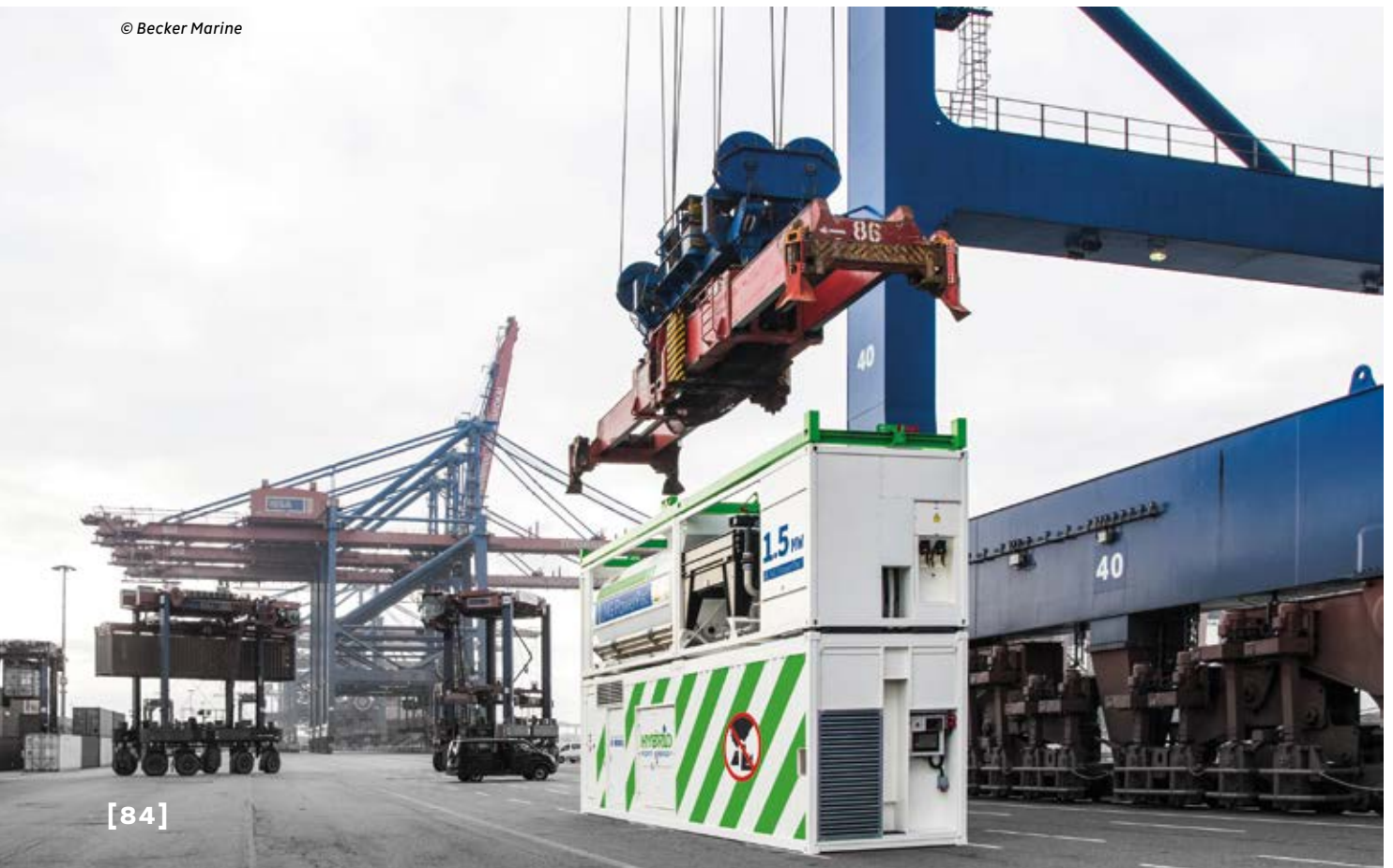
Standardmaß: Das Minikraftwerk auf LNG-Basis hat die Größe zweier übereinandergestapelter 40-Fuß-Container und lässt sich so einfach an Bord platzieren
