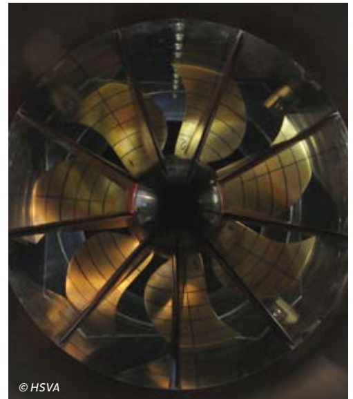
Beeindruckend: Kavitationstunnel-Umwälzpumpe mit einem Durchmesser von über vier Metern
