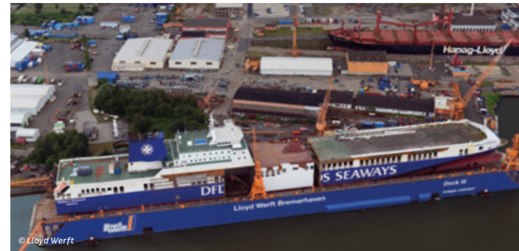
Die Frachtfähre PRIMULA SEAWAYS der dänischen Reederei DFDS wurde um 30 m verlängert
