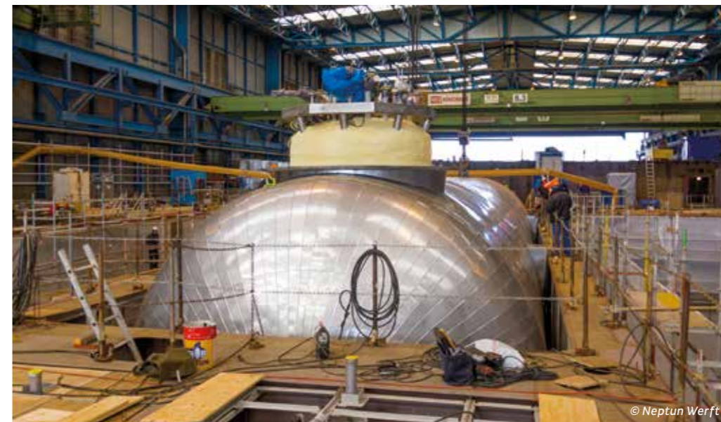
Schweregewicht: 28m lang und 200t schwer - LNG-Gastank für Kreuzfahrtschiffe
