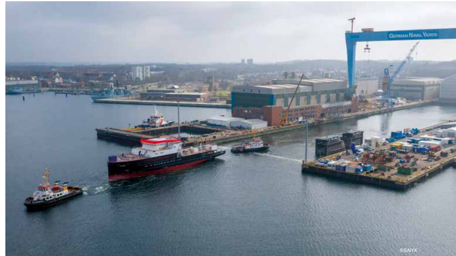
ATAIR: Erstes LNG betriebenes Forschungsschiff für das Bundesamt für Seeschifffahrt und Hydrographie (BSH)
